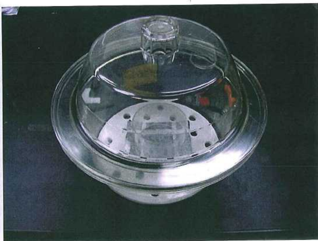
写真 4. 湿度 90%以上に保ったデシケーター内に設置したコンフォートシートの上にリングを設置（試験 3：シロアリを放す前）
